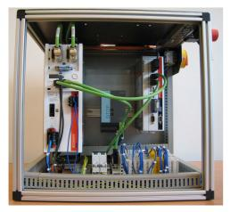
Le banc est constitué d'un PC industriel, d'un drive contrôlant deux moteurs brushless et d'entréessorties déportées, le tout géré par un réseau EtherCAT
